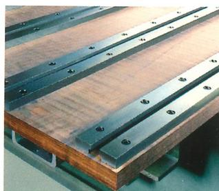
T-Nutenbahnen für Vorrichtungsträger
