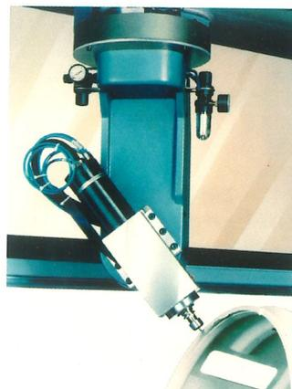
Das **Schnellläufer-Fräsaggregate** leistet 7,5 kW bei 36.000 1/min oder 8 kW bei 40.000 1/min und ist mit Werkzeugwechsler-System HSK 32/HSK 40 ausgestattet. 6 bzw. 10 Plätze stehen im mitfahrenden Magazin zur Verfügung.
